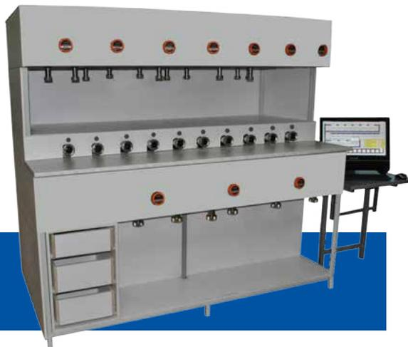
Установка поверочная СПУ-5 предназначена для воспроизведения единицы объемного расхода при поверке бытовых и коммунальных счетчиков газа. Проведение поверки счетчиков газа основано на сравнении результатов одновременных измерений объема воздуха поверяемым счетчиком газа и установкой. Результат измерений объема с помощью установки принимают в качестве действительного значения.
